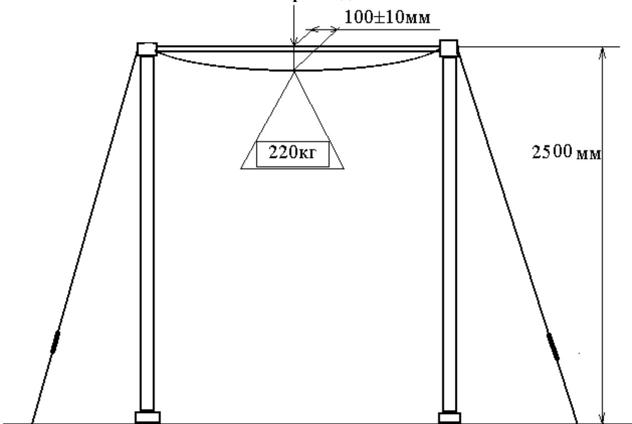
Высота стержня перекладины от пола - 1450-2550мм. Длина стержня перекладины - 2400мм. Диаметр стержня перекладины - 28мм. Площадь для установки перекладины - 9000x4500мм.
