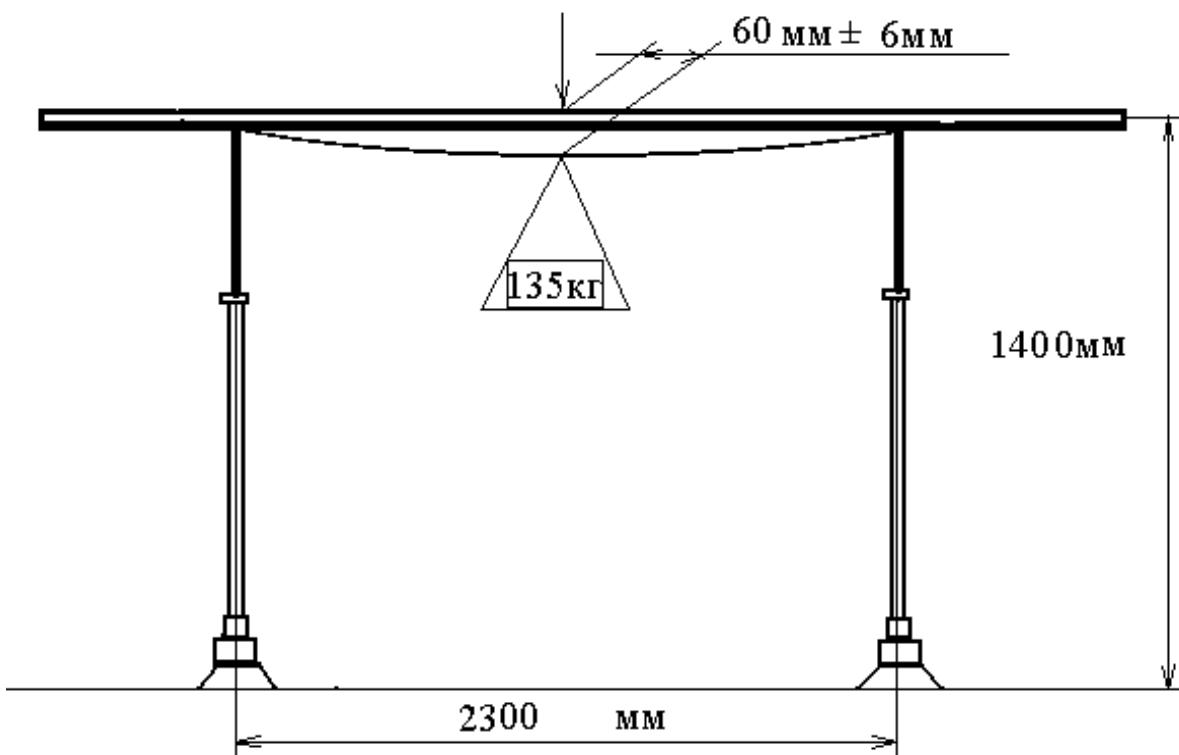
Расстояние по длине между стойками - 2300. Расстояние по ширине между стойками - 520. Высота жердей от пола - 1300-2100.
